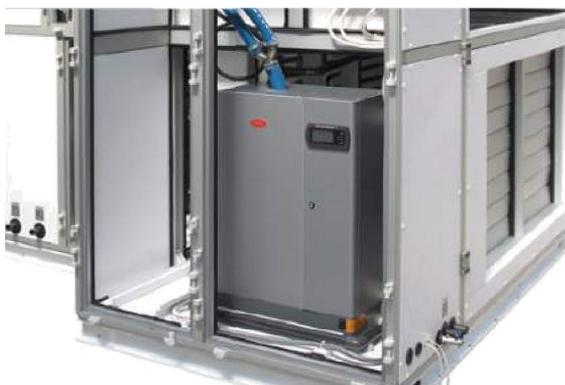
*Pendant l'hiver, nous récupérons jusqu'à 85% de l'HR (%) extraite de la pièce. Cependant, un humidificateur à vapeur supplémentaire doit être installé dans le MAX.E3-DH pour atteindre l'HR de la pièce nécessaire (%) ou pour produire l'humidité requise lors du démarrage de l'unité. L'humidificateur peut être entièrement intégré à l'unité ou installé dans le bâtiment, mais dans les deux cas, il est contrôlé par notre ICB.*
